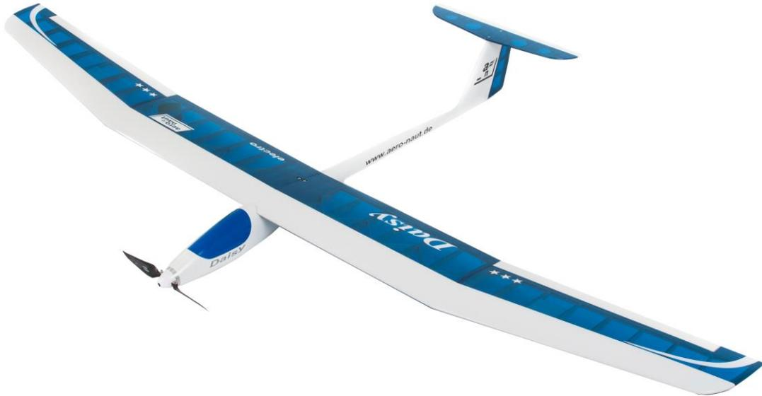
Bei Daisy handelt es sich um einen leistungsfähigen Elektrosegler, der sich bestens zum Erlernen der Basisgrundlagen des Fliegens eignet. Das Modell wurde mit einem zweiteiligen Tragflügel konstruiert, der mit einem SD7037 Profil gebaut wurde. Zur Erhöhung der Verwindungssteifigkeit wurde die vordere Flächenhälfte mit Balsa beplankt. Die Flächen werden mittels einem Stahl verbunden und auf den Rumpf geschraubt.
